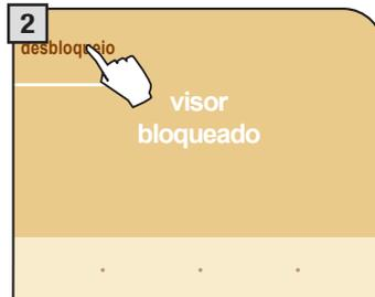
Para reactivar o visor pressione “desbloqueio” em baixo à direita e sucessivamente (dentro de dois segundos) “desbloqueio” acima à esquerda (essa tecla aparecerá só depois de pressionada a anterior).
