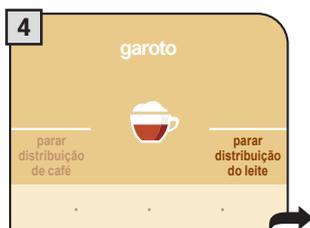
Depois de terminada a distribuição de café, a máquina preparará automaticamente o leite quente.
