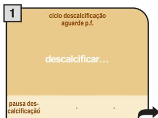
A máquina iniciará por distribuir a solução descalcificante através do tubo de distribuição de água quente. A distribuição acontecerá por intervalos preestabelecidos, para permitir agir à solução de forma eficaz.
