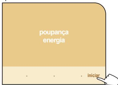
Para activar a máquina pressione "iniciar". Depois de realizado o diagnóstico das funções e a fase de aquecimento, a máquina estará de novo pronta para funcionar.
